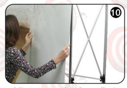
Lasciare delicatamente cadere il pannello, in modo da permettere il suo corretto posizionamento in sede. Assicurarsi che il nastro magnetico sul retro della grafica aderisca perfettamente alla barre magnetiche verticali della struttura.
