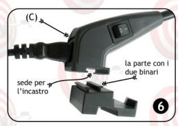
La lampada (C) ha una scanalatura al di sotto, che è la sede per l'incastro a scorrimento della base. La base ha, nella parte superiore, due binari. Questi devono essere posizionati in alto verso il retro della struttura in alluminio (A).
